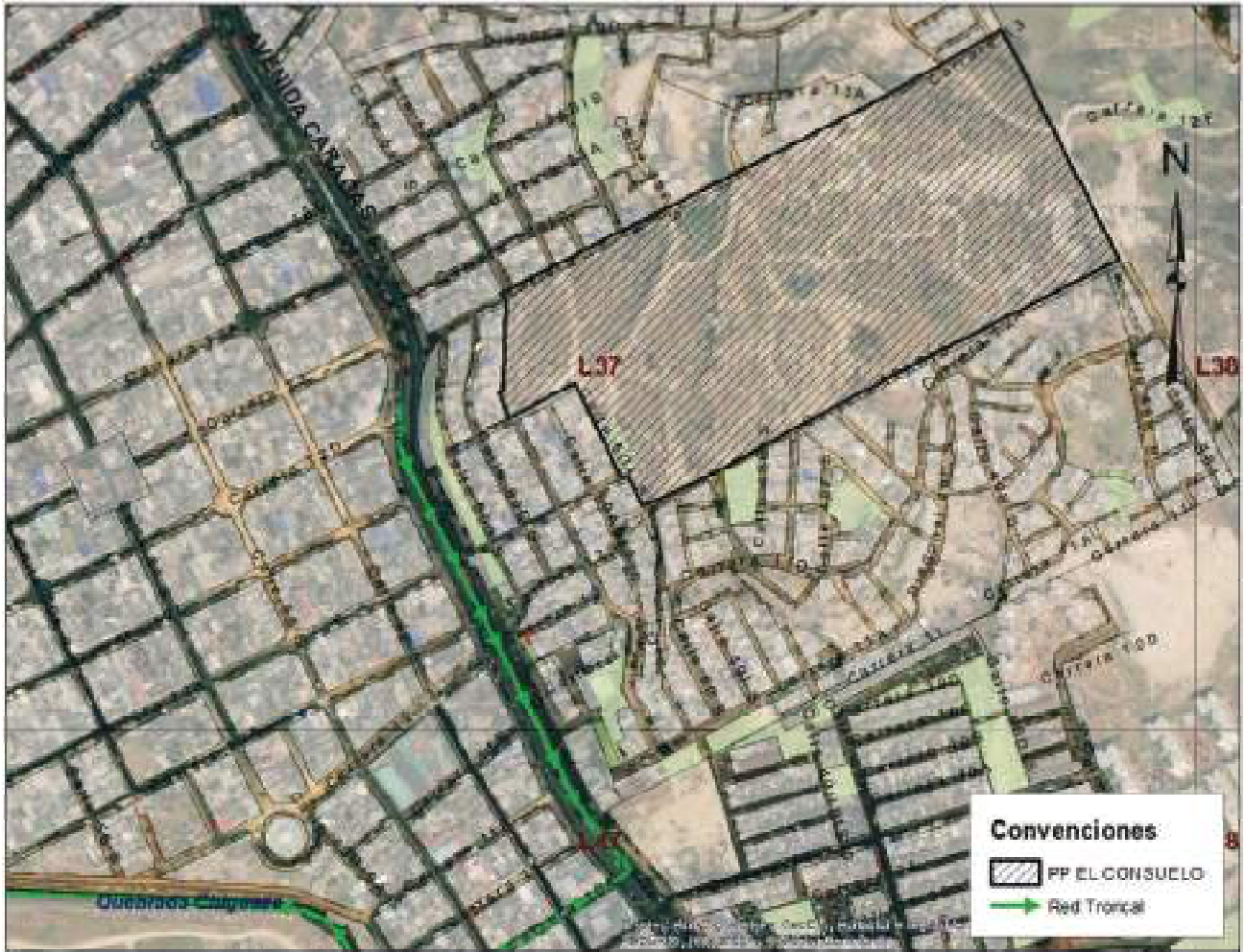
Ilustración 5. Red Troncal existente de Alcantarillado Pluvial
